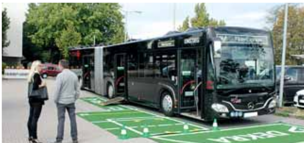
Der grüne Teppich verdeutlicht die Sichtbereiche für das Fahrpersonal
